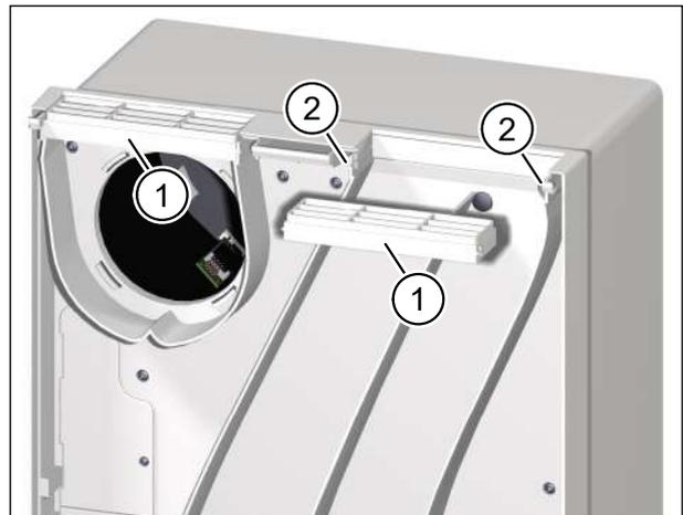
Abb. 10: Luftgitter reinigen (bei Aufputz- oder Unterputzmontage ohne Kanalanschluss)
