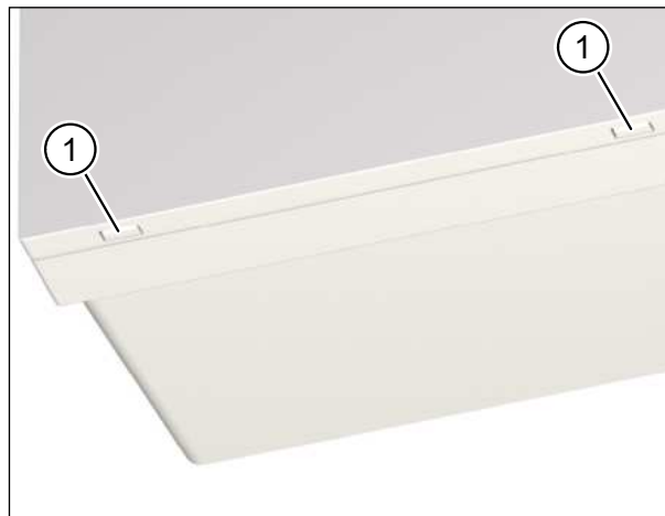
Obr. 15: Sejmutí víka z větrací jednotky
